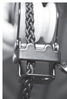
Mise en place de la corde dans le frein
